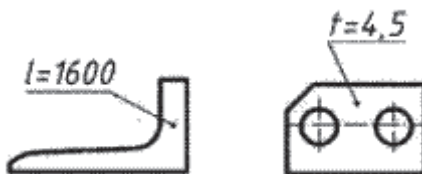
Joonis 33. Detaili pikkuse ja paksuse märkimine
